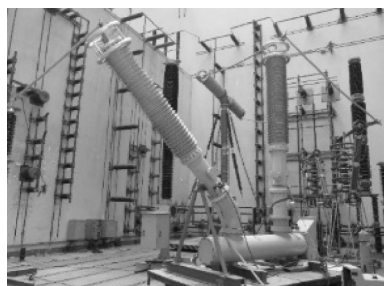
图10 断路器开断试验 Fig. 10 GCB interrupting test
