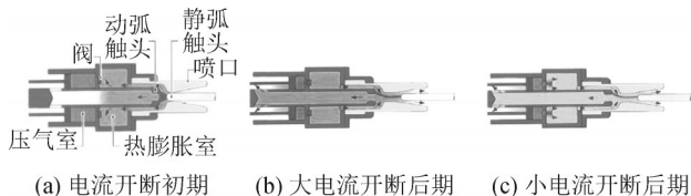
图4 自能灭弧室工作原理
